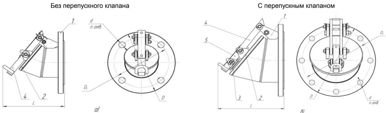
1 - корпус, 2 - клапан основной, 3 - клапан перепускной, 4 - рычаг основной, 5 - рычаг клапана перепускного
