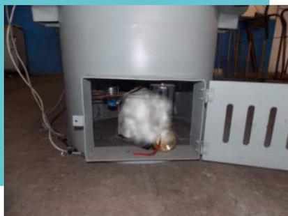
3) Газовоздушная смесь из контрольной камеры, проходя через кассету, попадает в камеру сгорания. В камере сгорания происходит воспламенение газовой смеси свечей зажигания.
