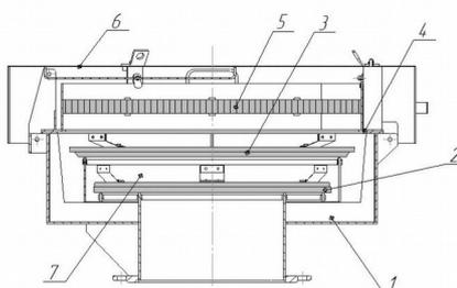
1 — корпус; 2 — клапан вакуума; 3 — клапан давления; 4 — крышка корпуса;
