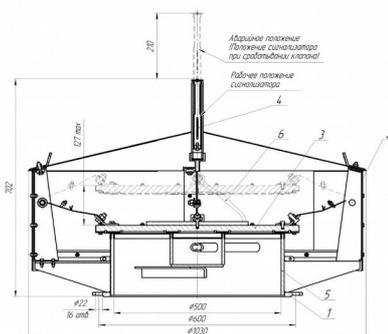
1 - крепежный фланец; 2 - корпус; 3 - клапан; 4 - сигнализатор; 5 - основание; 6 - рукав
